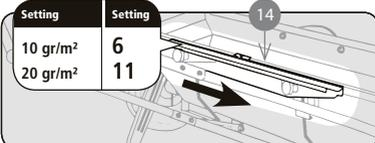
タイバー 14 を正しい位置にスライドさせポインターを推奨レートの目盛りに合わせて
